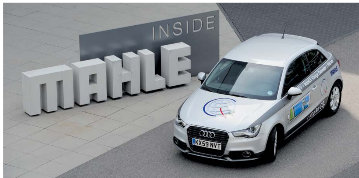
Von MAHLE in einem Audi A1 Konzeptfahrzeug erfolgreich umgesetzt: Elektromotoren erzeugen den Vortrieb, ein Verbrennungsmotor liefert die Ladeenergie für die Batterie – und ermöglicht so die Langstreckentauglichkeit.
