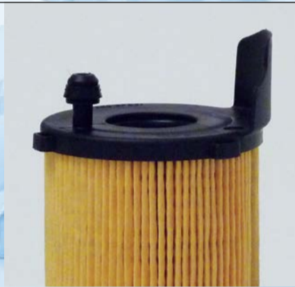
Der Nachbau mit Schwert verletzt so zwar nicht das MAHLE Patent, aber unter Umständen das Bypassventil am Motor!
