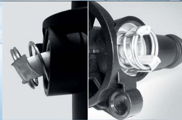
Detailansicht des folgeschädigten Bypassventils.
