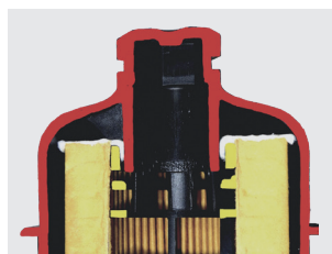
Ilustracja 2: Włókninę (białą) zaciska się po zamontowaniu między kołnierzem wewnętrznym (żółtym) a rurą (czerwoną) w taki sposób, aby uzyskać pełne uszczelnienie.
