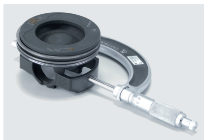
Figura 2: El recubrimiento añade aprox. entre 0,03 mm y 0,04 mm al diámetro especificado
