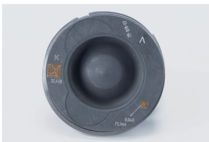
Figura 1: Las medidas del pistón, la holgura de montaje y la dirección de montaje figuran en el fondo del pistón
