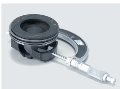
Figure 2 : Le revêtement ajoute environ 0,03 mm à 0,04 mm au diamètre spécifié
