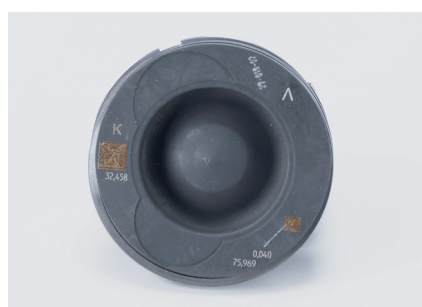
Figure 1 : Les dimensions du piston, le jeu et le sens de montage sont indiqués sur la tête de piston
