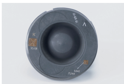
Ilustracja 1: Wymiar tłoka, luz montażowy i kierunek montażu podane są na denku tłoka
