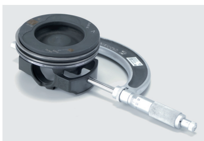
Ilustracja 2: Powłoka zwiększa podaną średnicę o ok. 0,03 mm do 0,04 mm
