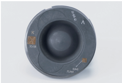
Resim 1: Piston ölçüsü, montaj boşluğu ve montaj yönü piston kafası üzerinde yer alır
