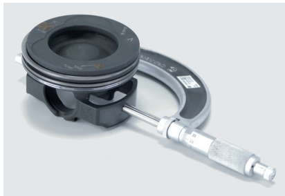
Resim 2: Kaplama, belirtilen çapa yaklaşık 0,03 mm ila 0,04 mm ekler
